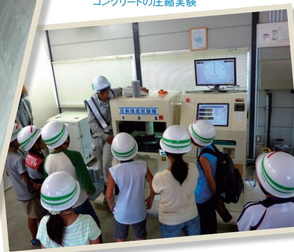
コンクリートの圧縮実験
