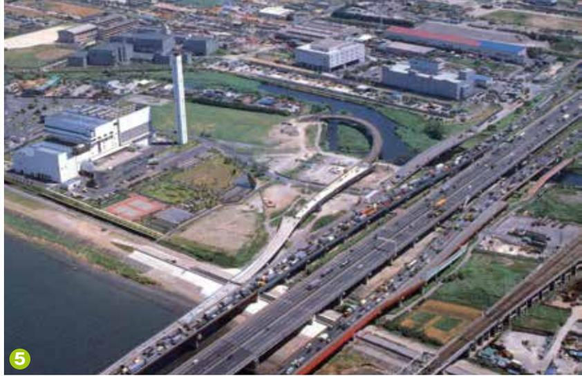
⑤ 高谷eランプ建設中の様子。埋め立てられていたゴミを動圧密工法で処理して施工した(『首都国道の挑戦 創立50周年記念誌』より)
